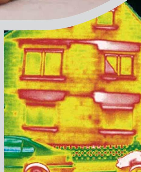
Geschlossene Rollladen senken den Wärmeverlust am Fenster um bis zu 37%.
