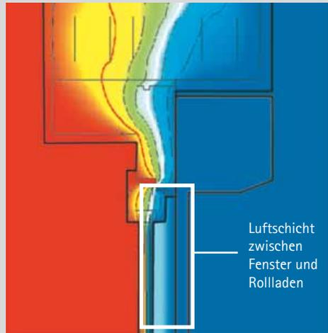
Die Luftschicht zwischen Fenster und geschlossenem Rollladen isoliert und wirkt wärmedämmend.
