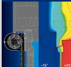
Ein geschlossener Rollladen ist ein energiesparendes Bauelement. Es lassen sich 20 bis 25% Energie einsparen. Dies ergab 2002 eine Untersuchung des Fraunhofer - Institutes.
