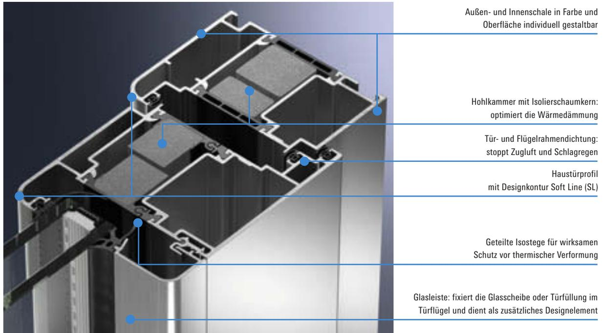
Beste Wärmedämmung im Profil: Schüco ADS 75 SL.SI (Soft Line.Super Insulation) mit einem  $U_f$ -Wert von 1,7 (in  $W/m^2K$  = Dämmwert des Türrahmens)
