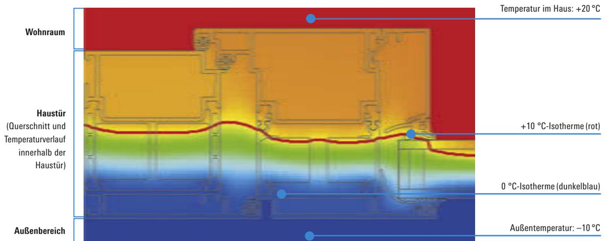
Querschnitt einer hochwärmegeämmten Aluminium-Haustür von Schüco. Der Isothermenverlauf zeigt: Trotz der Minusgrade außen herrscht auch direkt an der Haustür eine angenehme Innentemperatur.
